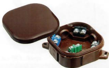
Puszka hermetyczna natynkowa bezhalogenowa PH KLIK 5 zacisków 4 mm 2 - IP54
