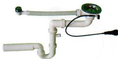
Syfon zlewu jednokomorowy z gardzielą 113mm z przelewem + automat przyścienny sitko nierdzewne
